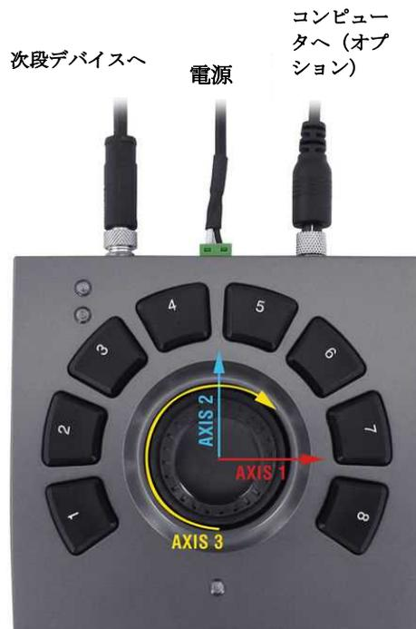
1. X-JOY3 および制御対象のすべての統合デバイスとコントローラーの電源を入れ、チェーンの最初に X-JOY3 と一緒にデ이지ーチェーン接続します。RS-232 の「前へ」および「次へ」コネクタを使用します(詳細については、デ이지ーチェーンデバイス(Daisy-Chaining Devices)を参照してください)。多くの製品は、デ이지ーチェーンケーブルを介して電力を共有しています。それぞれの電源インジケータが点灯します。
